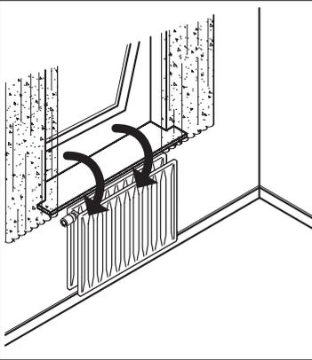
Danfoss Eco™ оснащен функцией определения открытого окна, которая закрывает клапан при резком снижении температуры в помещении, сокращая потери тепла.
