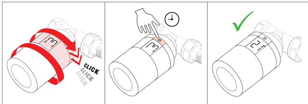
Навинтите Danfoss Eco™ на смонтированный переходник до щелчка. Закрепив термостат, поверните дисплей в удобное вам положение.
